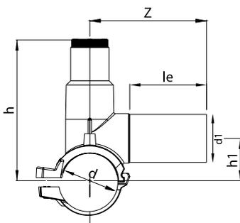
Injected monoblock type / Моноблок литой
