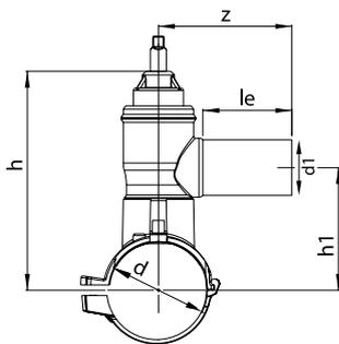
Injected monoblock type / Моноблок литой
